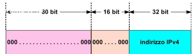
Usato per fare tunneling di IPv4 su infrastrutture IPv6
