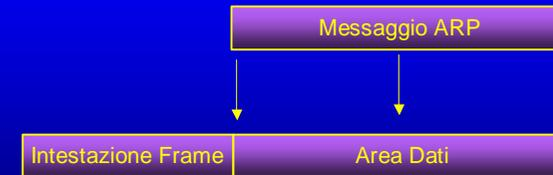
Nell'intestazione è specificato il tipo di trama trasportato: ad esempio in Ethernet  $0806_{16}$
