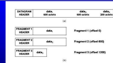
Ogni frammento contiene un intestazione derivata da quella originale con esclusione del FLAGS che indica il frammento e TOTAL LENGTH che indica la dimensione e OFFSET per lo scostamento
