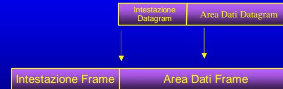
Nell'intestazione è specificato il tipo di trama trasportato: ad esempio in Ethernet 0800<sub>16</sub>
