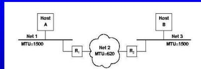
Le reti 1 e 3 hanno mtu di 1500 ottetti (tipica di Ethernet) i router frammenteranno i datagram  $R_1$  quelli inviati da A a B e  $R_2$  quelli da B ad A; IP rappresenta lo scostamento dei dati in multipli di 8 ottetti la frammentazione deve avvenire scegliendo la dimensione in modo da avvicinarsi il più possibile alla MTU. Solitamente l'ultima parte del datagram è più corta.
